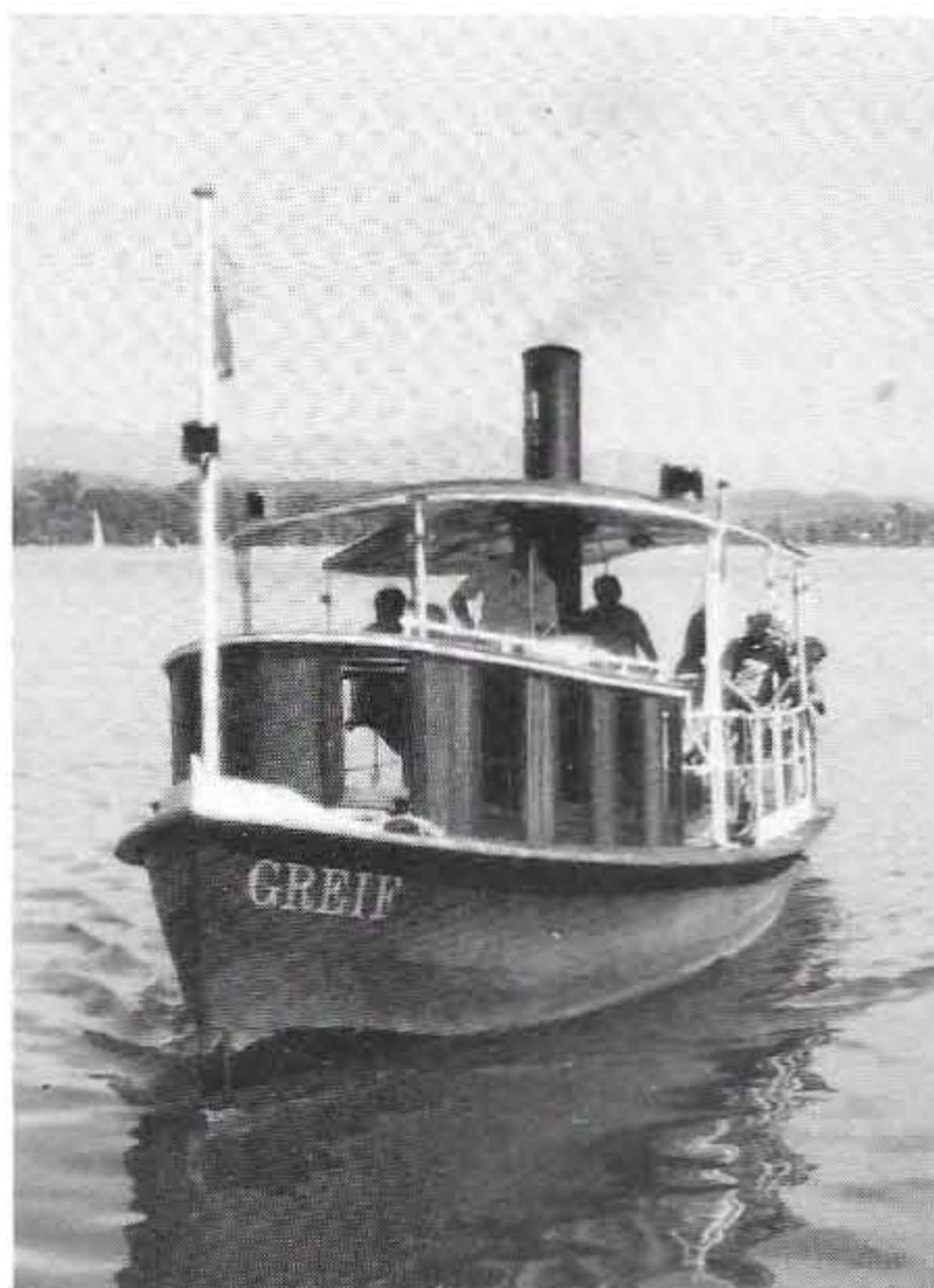
Bild 30. DS Greif auf dem Greifensee: ältestes und einziges mit Kohle befeuertes Dampfschiff der Schweiz
